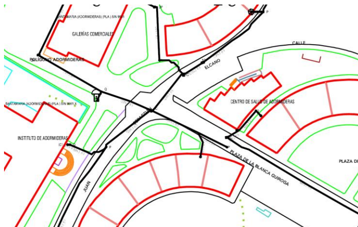
Imagen 66.- En el barrio de Adormideras se aprecia la variada ramificación para atender a las acometidas.
