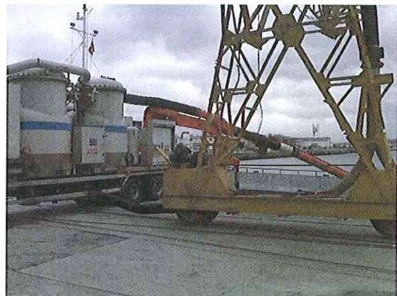
Detalle de la descarga de un buque de alúmina en el Muelle de Batería con destino a la instalación de Alcoa Inespal.
