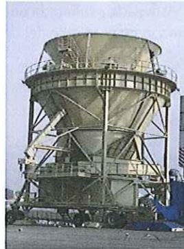
Detalle de una de las tolvas ecológicas para la descarga de graneles ubicada en el Muelle del Centenario.
