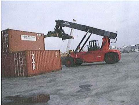
Detalle de un spreader en la Terminal TRA, manipulando un contenedor.
