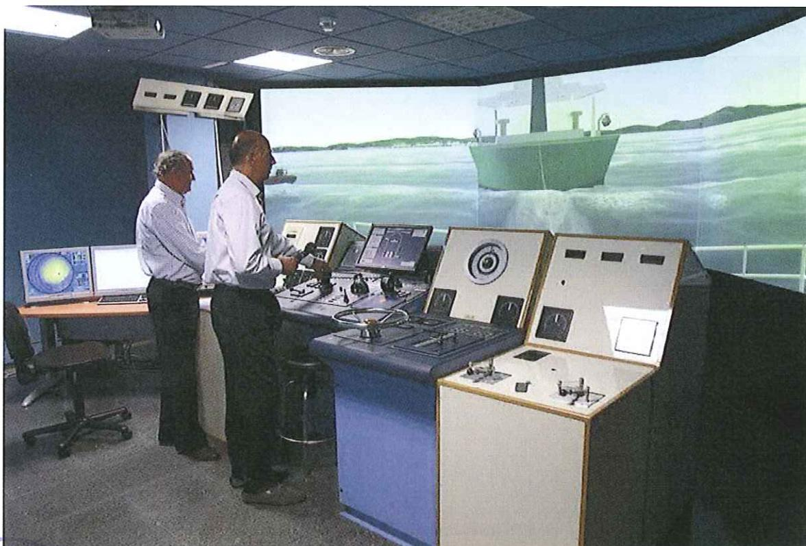
Figura 22. Puente secundario utilizado para el pilotaje de los remolcadores de altura ASD
