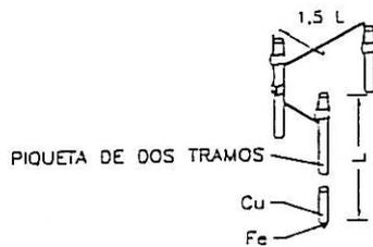
Cuando el subsuelo no puede ser penetrado o presenta una resistividad superior a la superficial, se puede disminuir la resistencia clavando dos o mas picas en paralelo.
