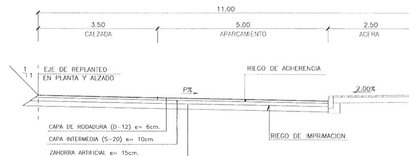
SECCION TIPO EJE UNIDIRECCIONAL CON APARCAMIENTOS (VIA-5)
