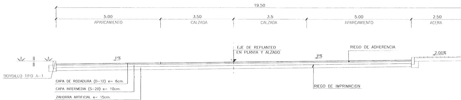
SECCION TIPO EJE BIDIRECCIONAL CON APARCAMIENTOS(VIA-2 Y VIA-3)
