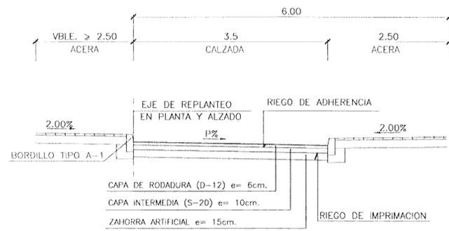
SECCION TIPO EJE UNIDIRECCIONAL(VIA-1)
