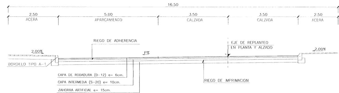
SECCION TIPO EJE BIDIRECCIONAL CON APARCAMIENTOS(VIA-4)
