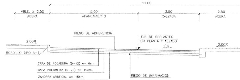
SECCION TIPO EJE UNIDIRECCIONAL CON APARCAMIENTOS (VIA-1)
