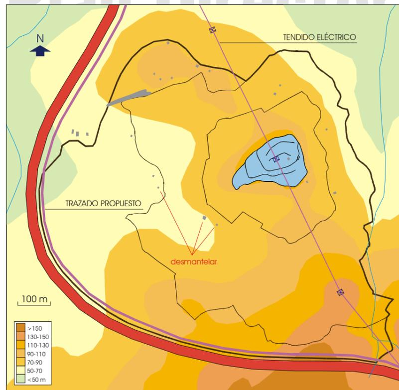
Fig. 32: La recuperación del espacio del Parque de Elviña: desmantelamiento de las construcciones agresivas y desplazamiento del tendido eléctrico.
